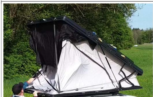
3. Ein Gummiband liegt um den Zeltkörper, es hilft Ihnen beim Zusammenbau die Zeltcanvas nach innen zu ziehen. Ziehen Sie dieses Gummiseil nach unten, und fixieren es an der unteren Zeltschale.
